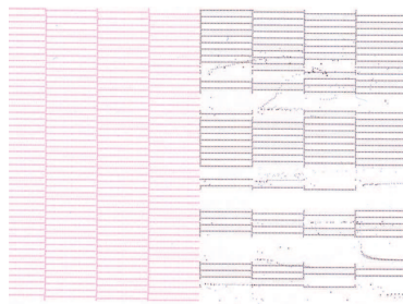
ノズル詰まり
